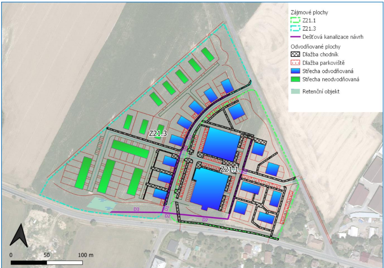
2. návrh dešťové kanalizace
